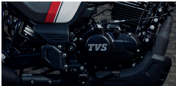
Moteur 225 cm 3 avec Glide Through Technology (GTT).
