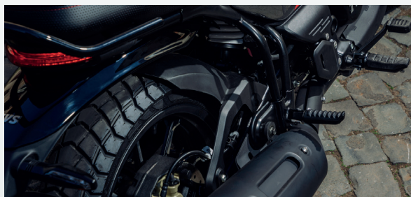
Cadre double berceau à haute rigidité.
