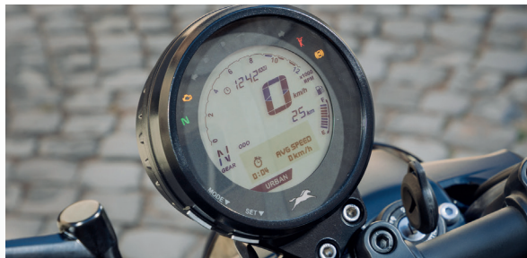
Console digitale asymétrique SmartXonnect avec Bluetooth, affichant données de conduite, navigation et notifications smartphone.
