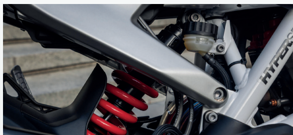
Mono-amortisseur réglable et boucle arrière aluminium.
