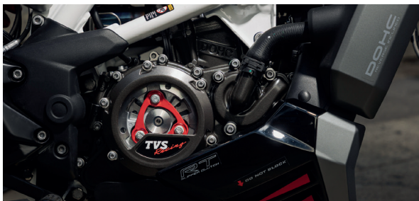
Moteur 310 cm 3 incliné vers l'arrière avec injection électronique
