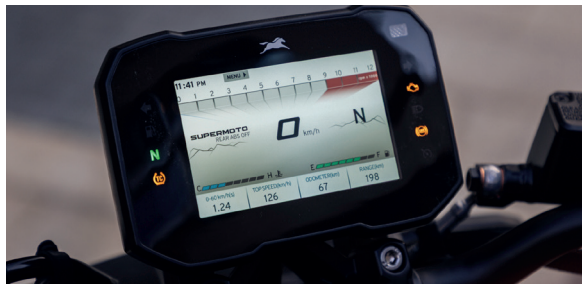
Écran TFT 5" avec connectivité SmartXconnect, navigation, modes de conduite et régulateur de vitesse intégré.
